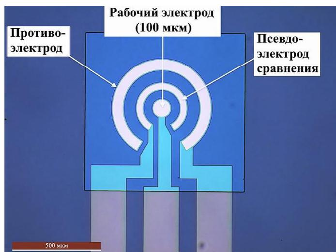
Рис. 1. Топология тестовой структуры, включающей трехэлектродную ячейку на кристалле
